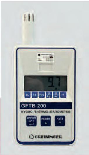
Das digitale Messgerät (Hygro-/ Thermo-/Barometer) zeigt auch die absolute Luftfeuchtigkeit innen und außen an.
